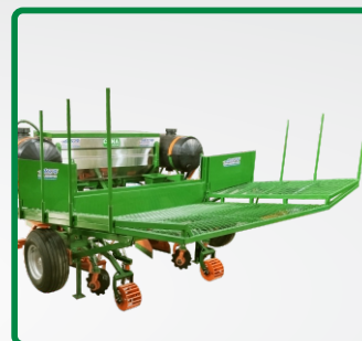
RESERVATÓRIO DE MUDAS
