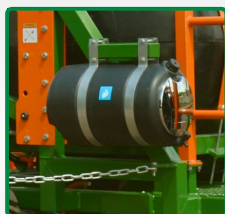
RESERVATÓRIO DE ÁGUA
