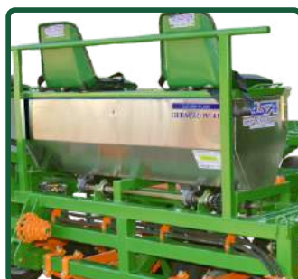
RESERVATÓRIO DE ADUBO
