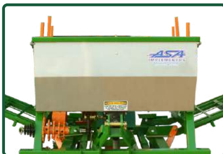
RESERVATÓRIO DE ADUBO
