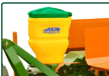
RESERVATÓRIO DE ADUBO
