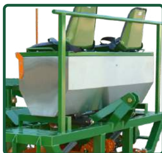
RESERVATÓRIO DE ADUBO
